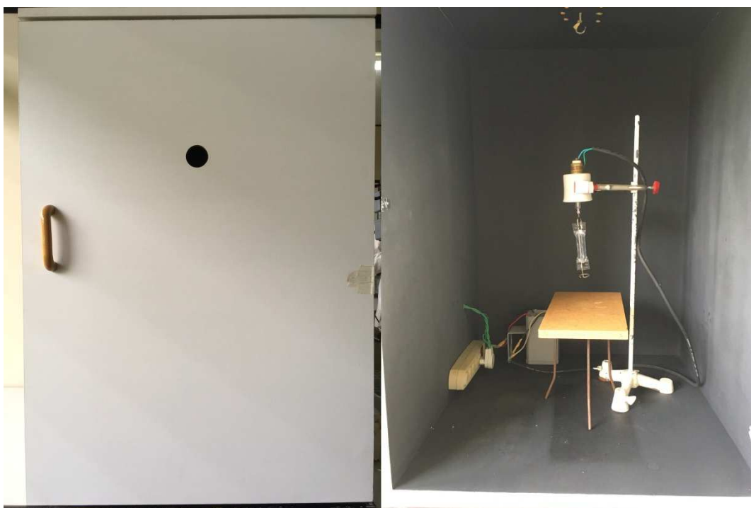
Figura 5. Digestor UV utilizado no preparo das amostras por Foto-Oxidação UV (Fonte: Arquivo pessoal).
